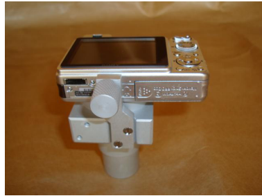
Sistema de Captura de Imagem (pode adaptado em qualquer microscópio ou estereoscópio)
